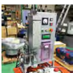
装置名 半自動式増締機 型 式 SCP-1HB 特 徴 防爆対応
