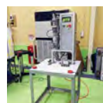
装置名 半自動式増締機 フレーム付 型 式 SCP-1H 特 徴 キャスター付で移動可能
