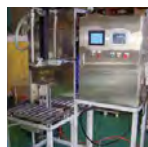
装置名 半自動重量式 充填機 型式 WF-1HB 特徴 耐圧防爆対応
