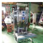
装置名 半自動重量式 充填機 型式 WF-2H200 特徴 2連仕様
