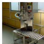
装置名 半自動重量式 充填機 型式 WF-1H200 特徴 シール充填対応
